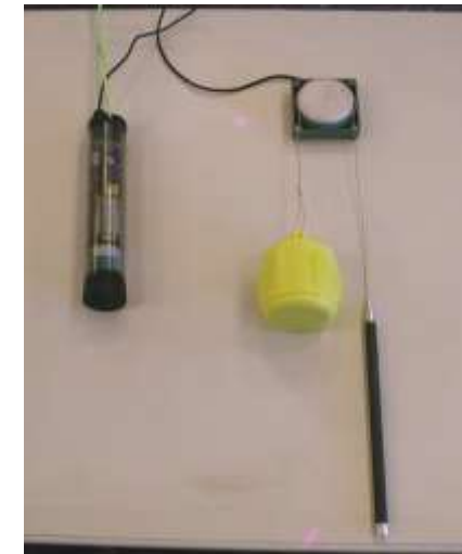
Limnógrafo digital Flotador con conversor angular
